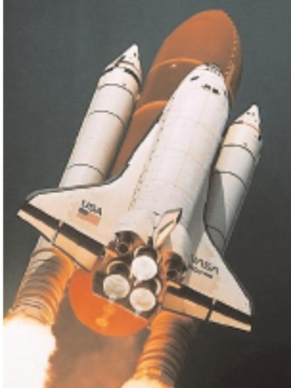
*Lancio dello Space Shuttle Atlantis per la missione STS-45 (24 marzo 1992). La dimensione del serbatoio principale (arancione) cui è fissato lo Shuttle rende bene l'idea della enorme quantità di combustibile, che costituisce anche la massa di reazione, necessaria per questi lanci.*
