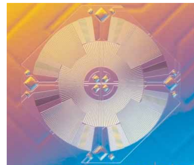
Accelerometro micromeccanico. Questo sensore è impiegato nei sistemi elettronici di controllo di stabilità delle automobili.
