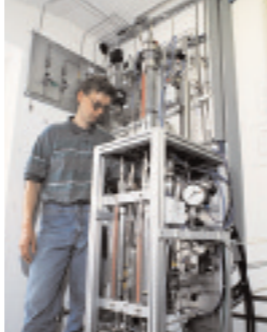
Cella per elettrolisi dell'acqua.
