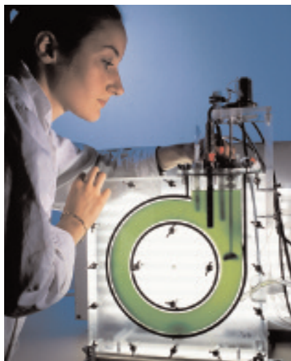
Bioreattore che genera idrogeno utilizzando alghe. L'energia necessaria è fornita dalla luce.
