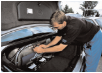
Il tecnico in fotografia sta lavorando sul serbatoio a idrogeno di un'auto BMW a bassa emissione. L'idrogeno è mantenuto liquido a -253°C grazie a 70 strati isolanti di alluminio e fibra di vetro.
