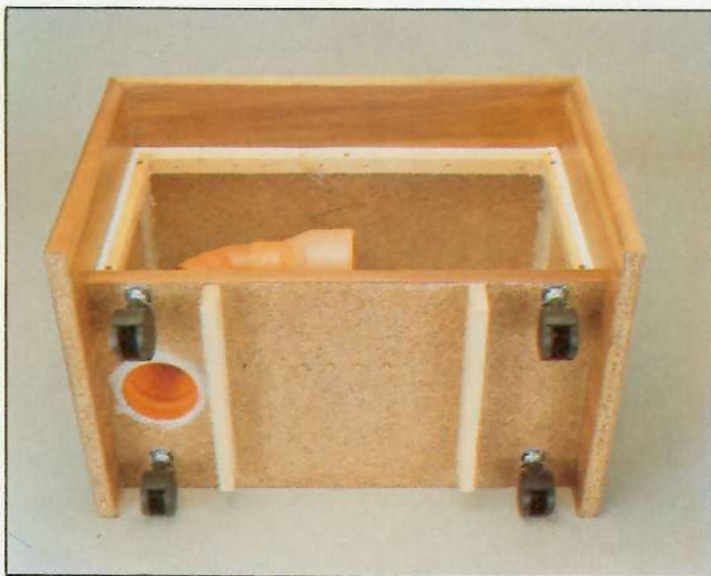
I morsetti d'ingresso sono realizzati con dei bulloni d'ottone da 4 mm avvitati sul pannello inferiore, dove vanno predisposte le fiancine per il montaggio della sezione elettronica ed eventuali rotelle o perni di sostegno.
