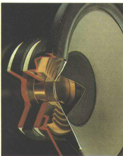
Figura 9 - Struttura interna di un altoparlante magnetodinamico. La bobina mobile è collegata rigidamente al cono, a sua volta sospeso al cestello per tramite della sospensione esterna (bordo) e del centratore. L'unico movimento consentito da questa configurazione è quello assiale.
