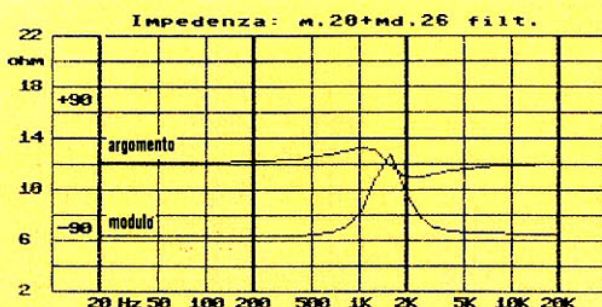
Figura 25 Modulo e fase dell'impedenza del sistema di figg. 20, 23, 24.
