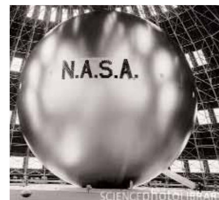
Test di gonfiaggio dell'Echo 1, il satellite, che doveva consentire le telecomunicazioni ad alta frequenza fra l'Europa e l'America riflettendo le onde verso terra, era un pallone di mylar alluminizzato. La foto è del 1958.
