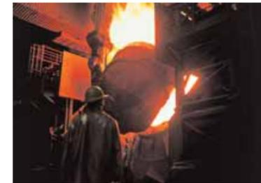
*L'acciaio, che è una lega ferro-carbonio, può essere addizionato di altri elementi per conferirgli caratteristiche particolari. Il tecnico controlla il versamento di ferro fuso in una fornace BOF, nella quale le impurità del ferro vengono convertite in ossidi facilmente asportabili.*
