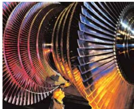
*Turbina a vapore per una centrale nucleare. Viene azionata dal vapore acqueo prodotto con il calore generato dal reattore. Si tratta di una turbina a vapore a bassa pressione.*
