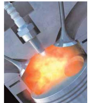
*Disegno al computer dell'interno del cilindro di un motore a scoppio. Nell'immagine viene mostrata l'accensione della miscela aria-benzina attuata con una scintilla elettrica da parte della candela. Grazie alla combustione della benzina, l'aria contenuta nella camera di scoppio si riscalda fino ad oltre 2.000°C ed espandendosi spinge il pistone verso il basso, raffreddandosi, quindi, fino alla temperatura di scarico (di alcune centinaia di gradi Celsius).*
