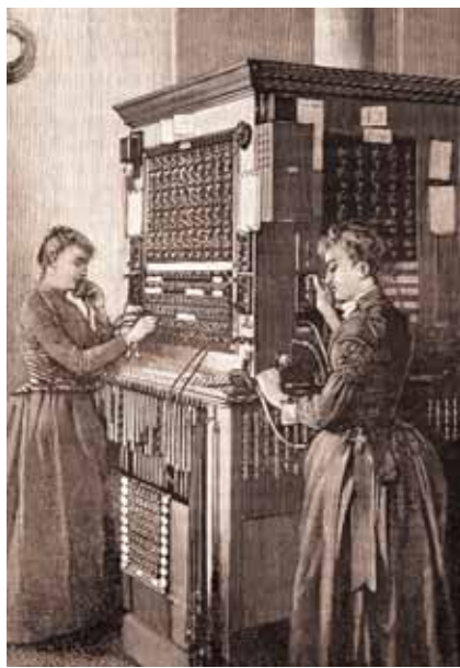
Una centrale di commutazione telefonica del 1890 a Parigi. Le connessioni erano attuate da operatrici manualmente. Sempre a Parigi, vennero impiegati per la prima volta i numeri telefonici al posto dei nomi delle persone che si volevano interconnettere e, grazie alla possibilità di automatizzare le selezioni successive, consentirono un notevole aumento della velocità nella commutazione delle linee.
