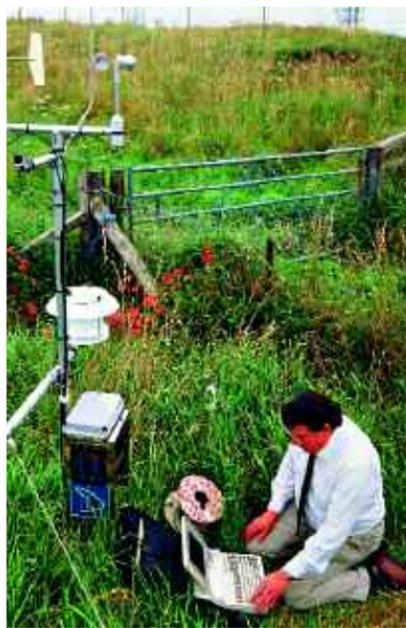
Una stazione automatica di monitoraggio del tempo atmosferico. I dati possono essere scaricati su un computer portatile ad intervalli regolari. La stazione comprende strumenti per registrare la direzione e la velocità del vento, la temperatura, l'umidità, e la quantità di radiazione solare.
