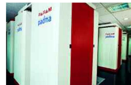
*Il supercomputer Param Padma, il più potente dell'India, capace di una potenza di calcolo di un Teraflop. Questo supercomputer viene usato per effettuare analisi basate su grandi quantità di dati, come quelle nei settori della bioinformatica, della meccanica strutturale, e della scienza dell'atmosfera...*
