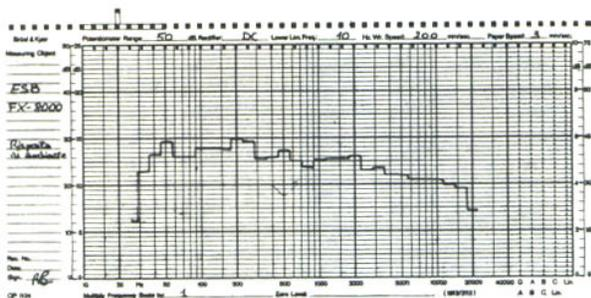
L'andamento ottimale della risposta in frequenza in ambiente d'ascolto, rilevata per terzi di ottava, è leggermente decrescente con l'aumentare della frequenza.
