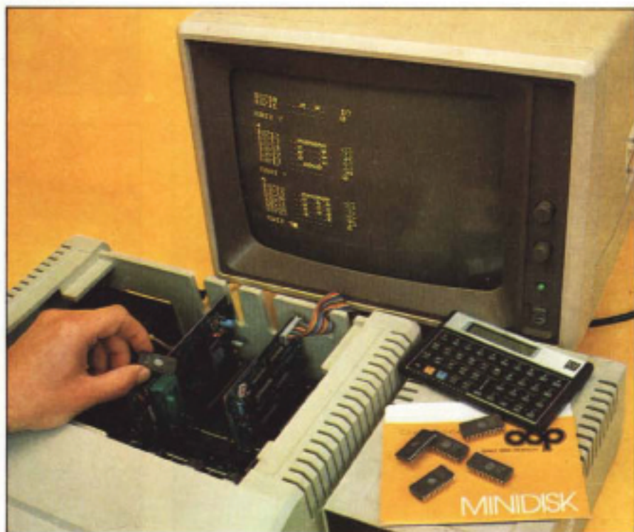
L'Apple-compatible utilizzato per la lettura e la programmazione delle EPROM. Sul monitor la visualizzazione dei caratteri in memoria; nella macchina è installata la scheda di programmazione; sul drive la HP16C utilizzata per le conversioni bin-dec.
